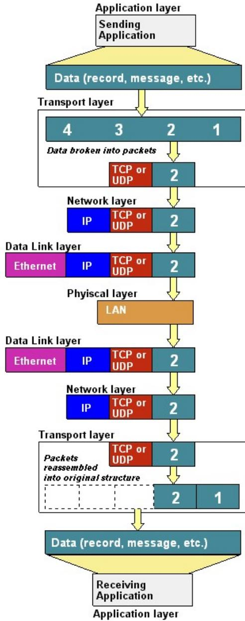
图 8.4: TCP IP Network Layer
