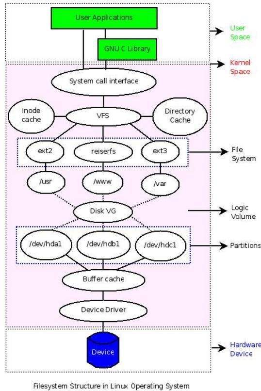
图 6.1: Linux FileSystem Architecture
